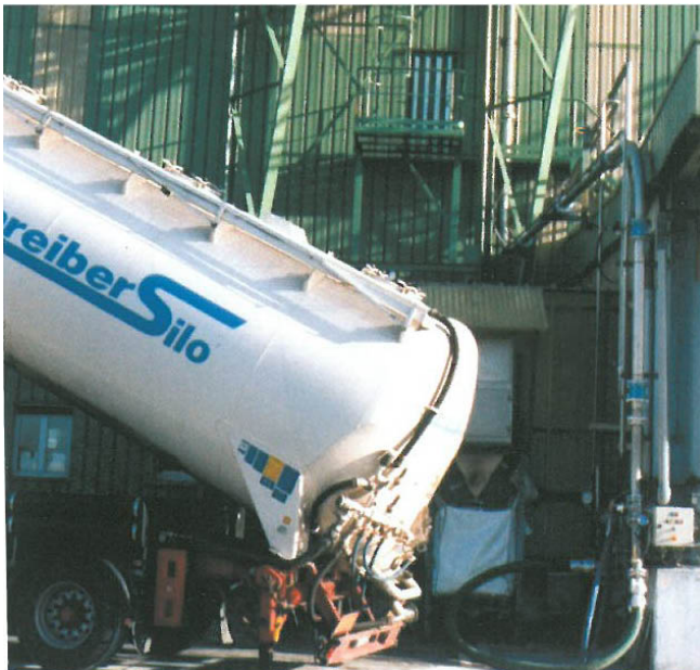
Abbildung 9 (oben links): Siloentladung nach Puls-Pneu Förderverfahren (Quelle SST)
