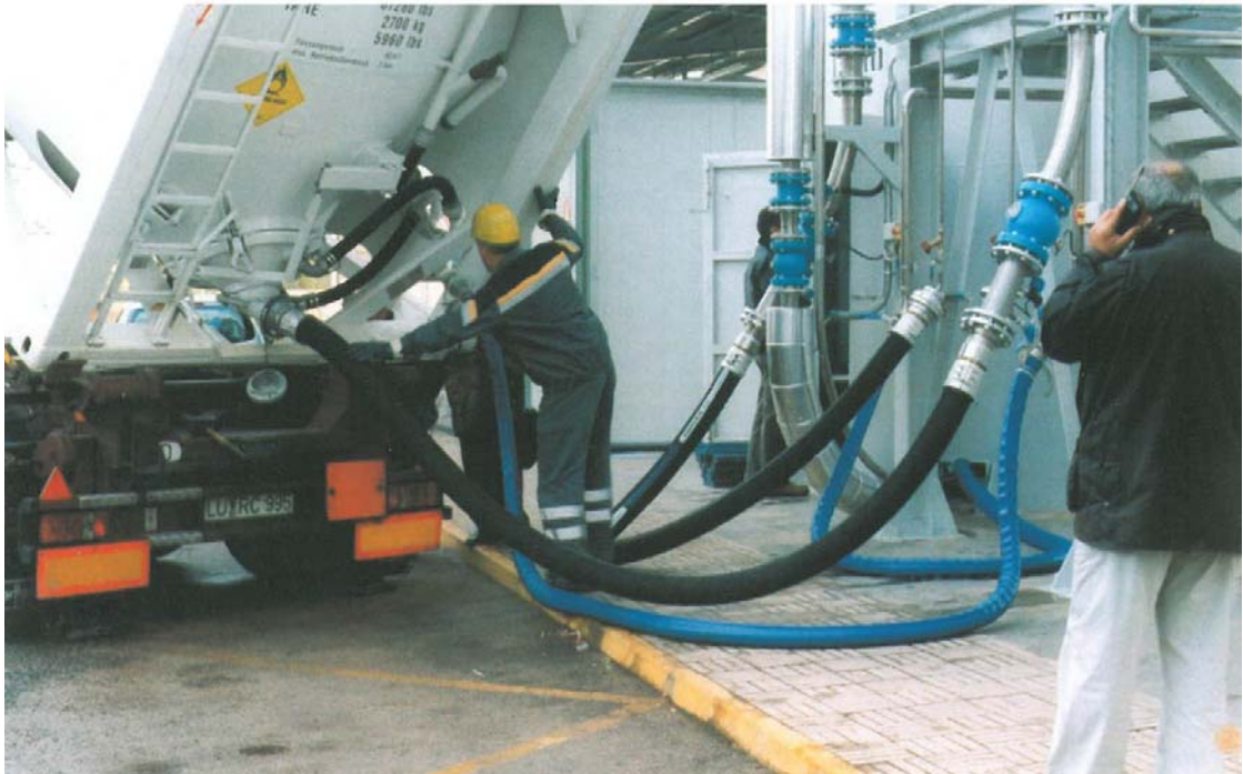
Abbildung 8: Silofahrzeugentladung (Quelle SST)
